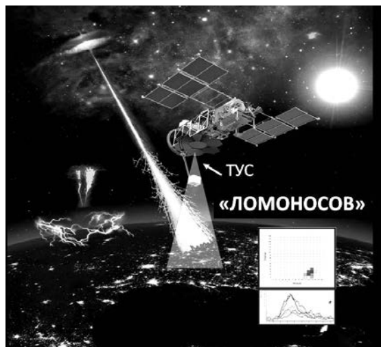
Рис. 8.6. Телескоп ТУС на борту спутника «Ломоносов», запущенный в 2016 г., стал первым в мире экспериментом по регистрации частиц КЛПВЭ из космоса. На нижней правой панели — один из сигналов — кандидатов в КЛПВЭ, зарегистрированный телескопом ТУС на фоне других световых транзитов в атмосфере (см. главу 11).
