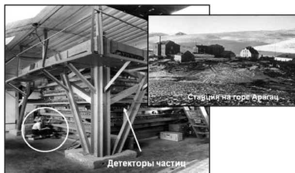
Рис. 3.11. Первый в мире ионизационный калориметр, созданный советскими и армянскими физиками и размещенный на горе Арагац на высоте 3200 м (г. Нор Амберд) Фотографии 60-х годов. В кружке – сотрудник лаборатории.
