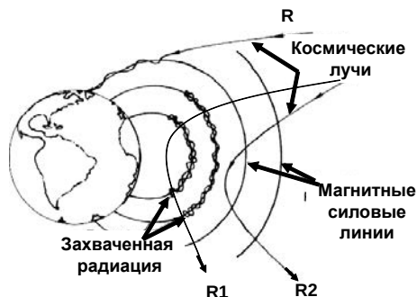
Рис. 14.1. Проникновение космических лучей в дипольное магнитное поле Земли. Частицы с большей жесткостью R1 проникают глубже внутрь магнитного поля, и часть их достигает атмосферы. В районе полюсов частицы проникают внутрь магнитного поля в широком диапазоне R . Внутри дипольного поля возможно формирование замкнутых траекторий (захват частиц).
